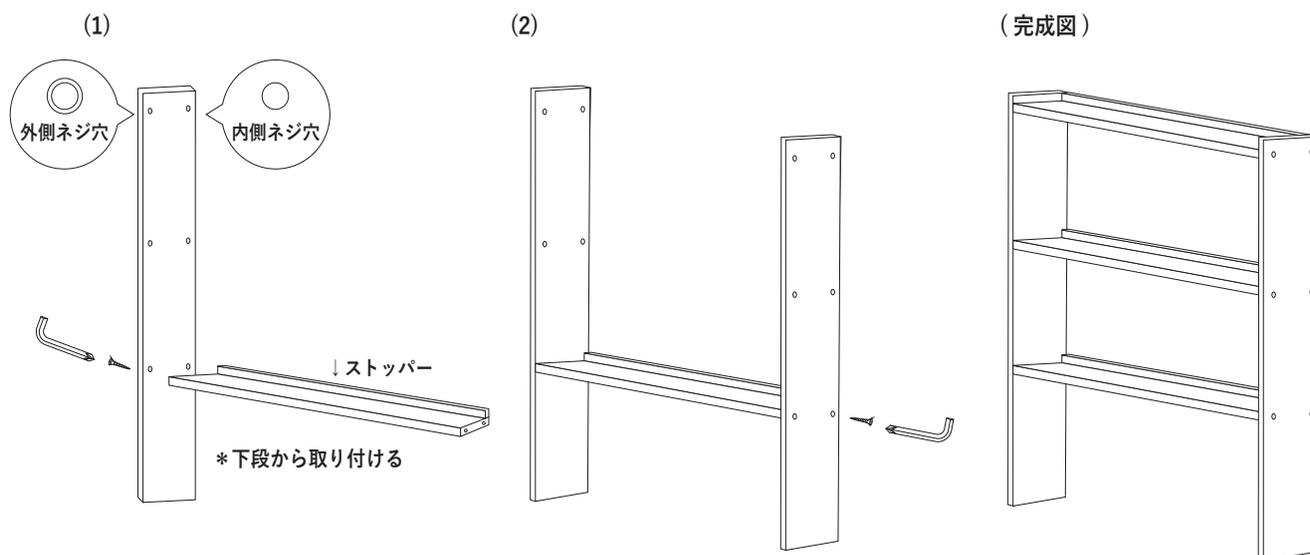
①側板の下段の外側ネジ穴に、②棚板の側面穴位置を合わせて、③ネジを外側から差し込み、④付属のドライバーで下の段から取り付けてください。棚板はストッパーの付いている方を上向きにしてください。
