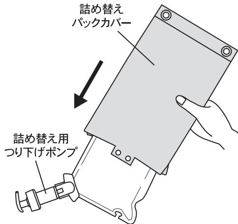
①1回分の詰め替えパック(400ml以下)を別売りの詰め替えパックポンプをセットした状態で上から本品をかぶせます。
